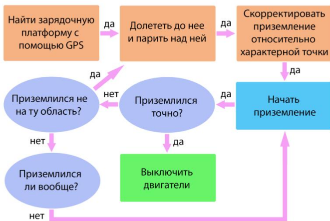
Рис. 3. Блок-схема работы системы приземления с учетом варианта неудачного приземления
