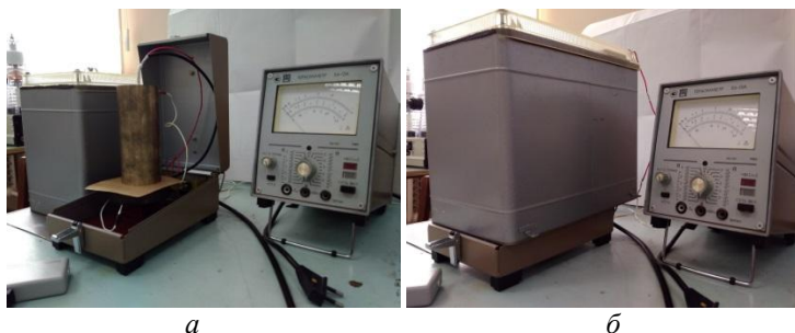
Рис. 1. Общий вид прибора и измерительной ячейки измерительная ячейка без экрана (а); ячейка с экраном (б)
