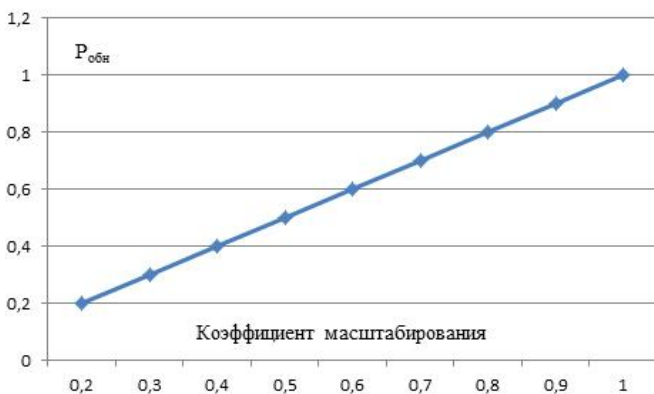
Рис. 4. График зависимости вероятности обнаружения от сжатия текущего изображения сцены
