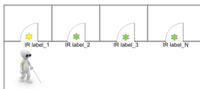
Рис. 2. Прокладывание маршрута следования внутри помещения по ИК-меткам
