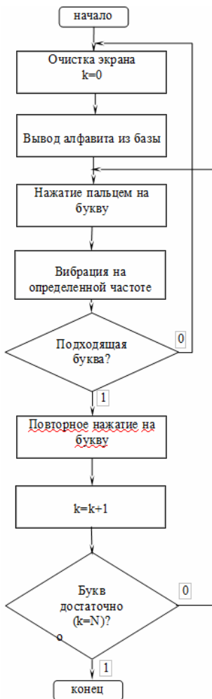
Блок-схема для ввода текста в устройстве с обратной тактильной связью
