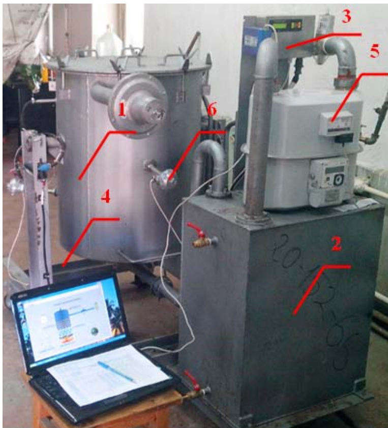
Рис. 1. Общий вид экспериментальной пиролизной установки ГВА-1: 1 – терморектор; 2 – гидрозатор; 3 – электронный блок контроля и управления; 4 – рама; 5 – газовое оборудование; 6 – датчики температуры
