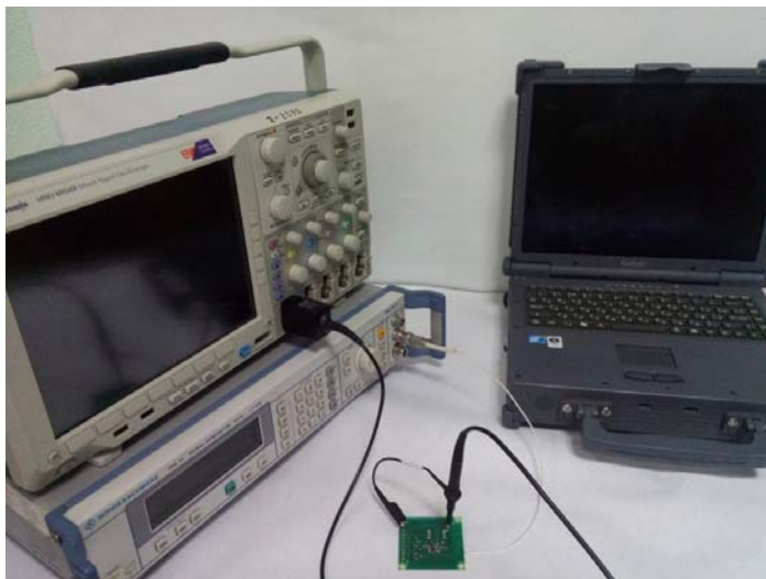
Рис. 2. Рабочее место для измерения чувствительности приемника
