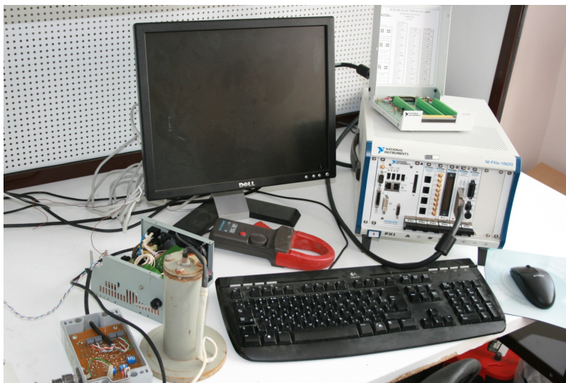
Рис. 2. Измерительное оборудование для измерения ГИТ в нейтрали силового трансформатора
