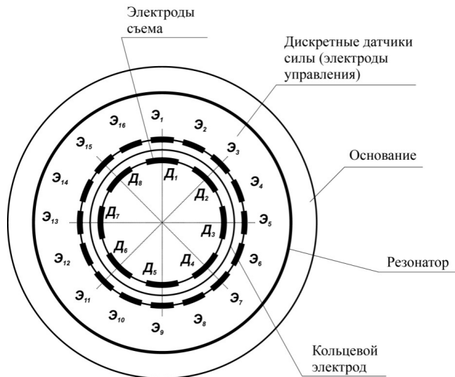
Рис. 3. Структурная схема чувствительного элемента
