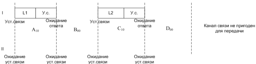
Рис. 5. Временные диаграммы для состояния П-ХСП
