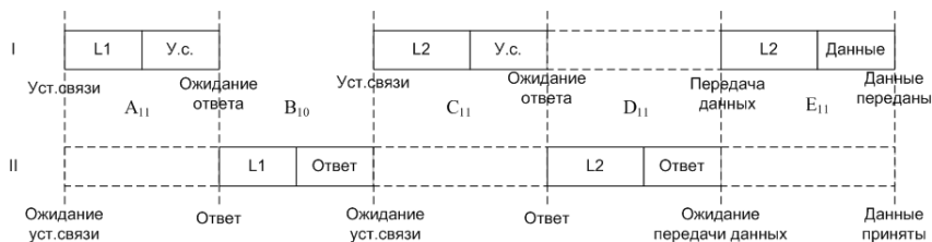
Рис. 2. Временные диаграммы для состояния X-C
