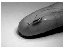
Рис. 5. Шаговый пьезодвигатель Кенджо Учино
